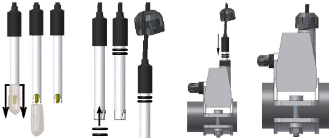
Fig. 3 – Bevestiging van de sensor in de sensorhouder
